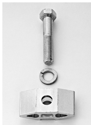
Lasche F15/4 mit Sechskant M10 x 55 Federring F6 verzinkt
